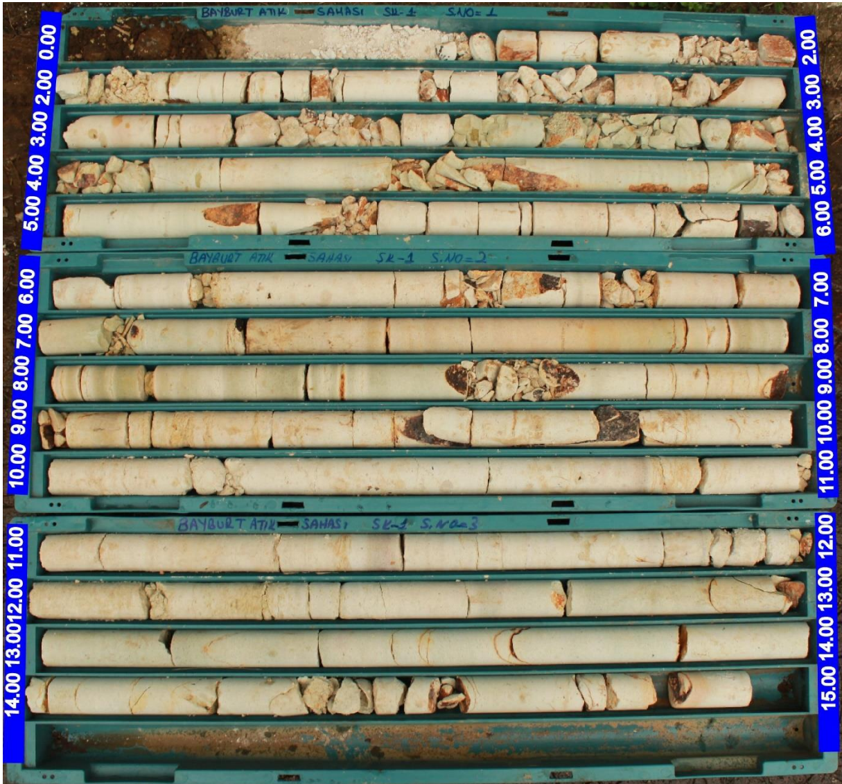
Şekil 72. Mevcut Atık Sahası Sk-1 nolu sondaj karotlarına ait fotoğraflar
