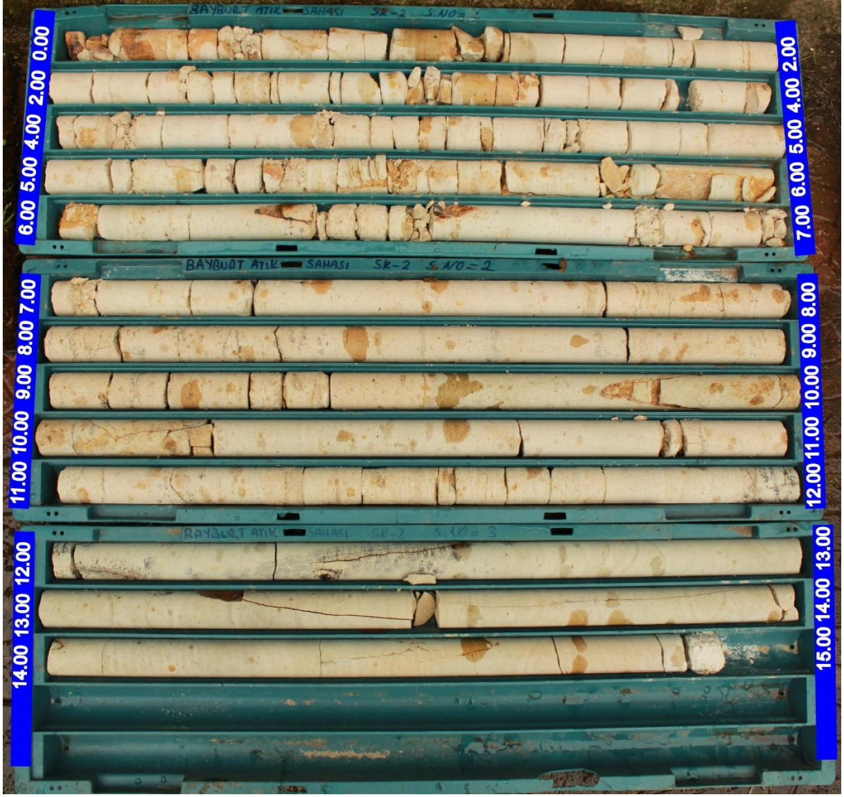
Şekil 73. Mevcut Atık Sahası Sk-2 nolu sondaj karotlarına ait fotoğraflar
